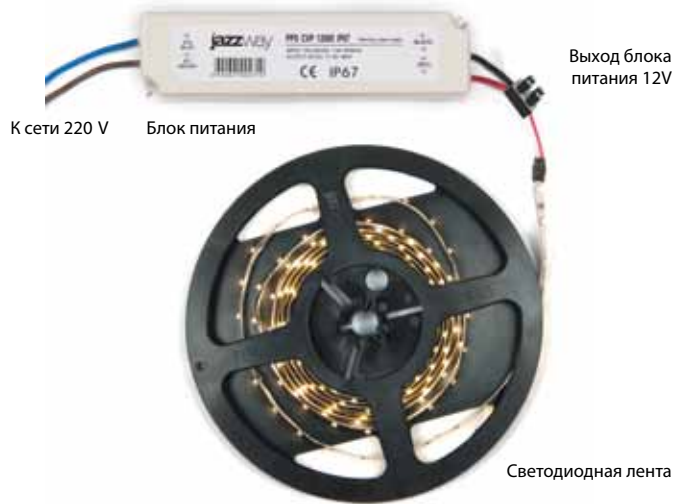
СХЕМА 1. Как подключить светодиодную ленту
