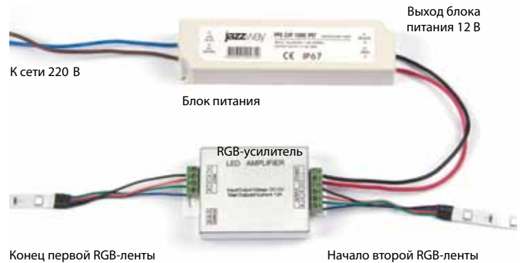
СХЕМА 6. Подключение усилителя мощности
