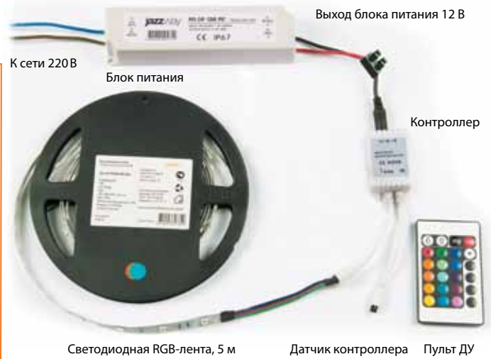
СХЕМА 5. Подключение многоцветной (RGB) светодиодной ленты
