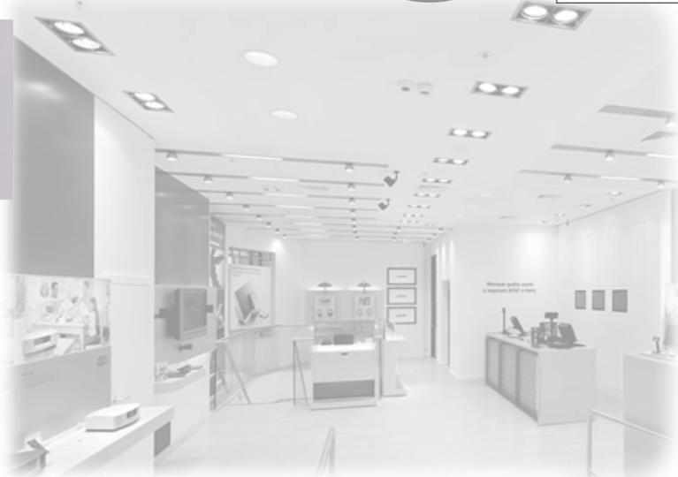
Светодиодные встраиваемые светильники **PSP-S CARDAN jazzway** предназначены для акцентного освещения объектов в жилых и общественных помещениях. Поворотный механизм позволяет менять направление светового потока в одной плоскости, угол поворота  $\pm 30^\circ$ .
